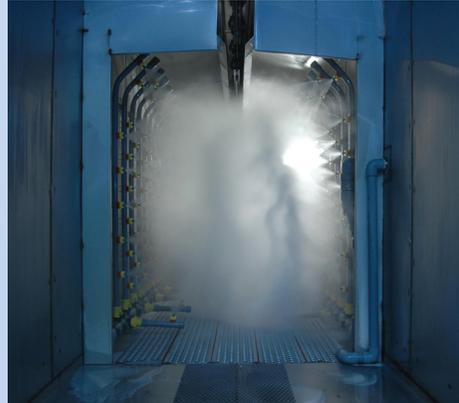
sowohl als Elektro- als auch als Pulverbeschichtung. So können wir ein großes Bedarfsspektrum der Automobilbranche abdecken. Die Elektrobeschichtung kann leicht an komplexe Konfigurationen angepasst werden, wobei die vorgegebenen Toleranzen eingehalten und die vorgesehene Funktionsmöglichkeit erhalten bleibt. In der Lackieranlage von Midway werden Innenflächen, tiefe Einsenkungen, Verschlüsse und Teile aller Größen mit einer einheitlichen Beschichtung ohne Nasen versehen.
